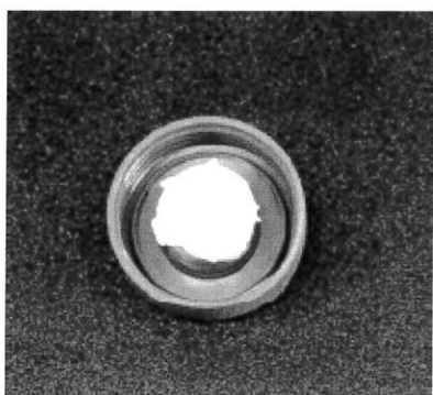
図15 イニシエーター挿入口の措置
